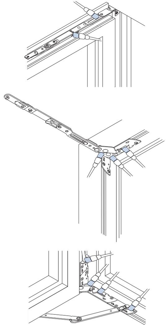
Schere (Flügel/Blendrahmen), Ecklager, Flügellagerschiene
