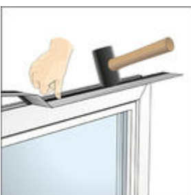
Bild 14: Geeignete Kederfolie in die äußeren Blendrahmen-Nuten einbringen
