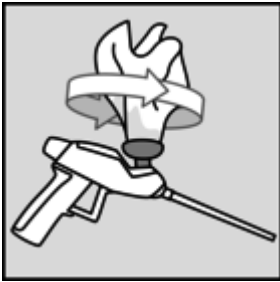
Reinigungsbild 7: Das Ventil der Pistole wiederholt mit einem sauberen Tuch reinigen
