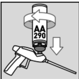
Reinigungsbild 3: Pistolenreiniger auf die Pistole schrauben
